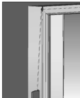
11. Den Wickler senkrecht gegenüber dem Ausgang der Schnur oder des Gurtes aus der Durchführung einbauen. Der Wickler soll sich auf der Höhe von nicht mehr als 1,8m vom Untergrund befinden.
