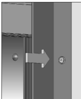
10. Sich vergewissern, dass der Rollläden sachgerecht ( waagrecht und senkrecht ) befestigt ist Die Schrauben in Führungen festdrehen und dann die Abdeckungen einlegen. Die sachgerechte Funktion des Rollladens prüfen. Die sachgerechte Funktion der automatischen Riegel oder des Verschlusses prüfen, bei regeln.
