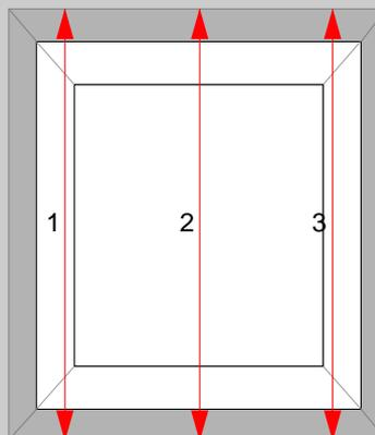
Messen Sie die Höhe an drei verschiedenen Stellen. Die kleinste Höhe ist die Bestellhöhe. Da der Kasten unter dem Fenstersturz montiert wird, ist die Höhe der Fensteröffnung gleich der Gesamthöhe des Rollladens.
