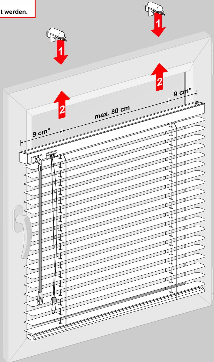
\* Der Abstand der Anbringung des Halters von der Aussenkante ist nicht immer gleich. Man soll die Träger nicht über bewegliche Getriebeteile montieren.
