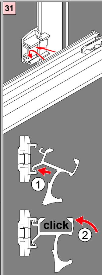
Demontage - Disassembly - Smontaggio - Demonta
