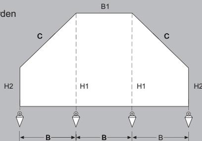
**Bitte nur lichte Maße angeben**, Abzüge werden durch das Werk ermittelt. Das **Maß C** wird als Kontrollmaß genommen. Ermitteln Sie die Maße mit großer Sorgfalt, da nur so der Winkel genau errechnet werden kann.
