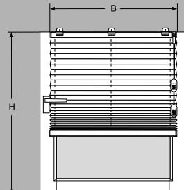
Bei Montage mit Klemmträgern in der Höhe (H) 10 mm abziehen.
